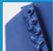
Segments avec des éclats de polycristallins
